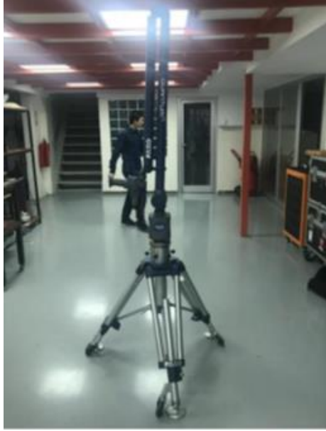
Şekil 3. FaroArm Edge 2.7 3B lazer tarama ölçüm cihazı
